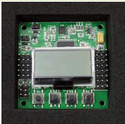
STEP-1 LCDが正面を向くように、フレームのFCとボタンが下側に設置。
